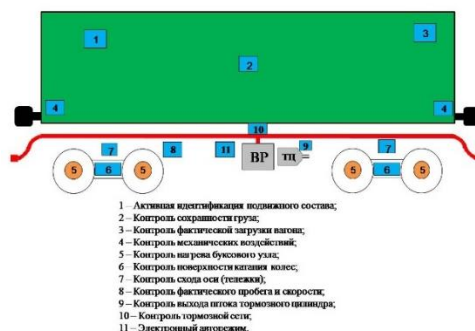
Рисунок 3 – Датчики, устанавливаемые на грузовом вагоне
