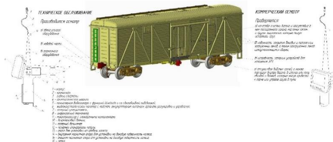
Рисунок 2 – Контрольно-диагностическое устройство для проведения операций по осмотру вагонов
