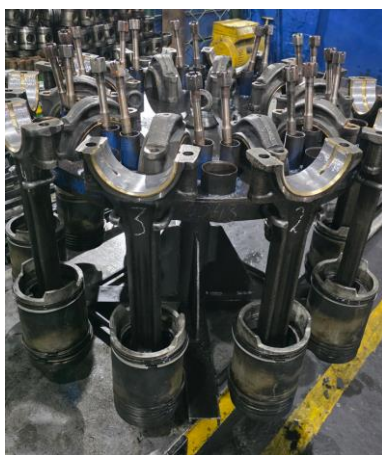
Рисунок 1 – Устройство для транспортировки ШППГ в Оренбургском СЛД
